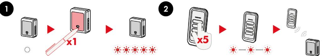
NB : La connexion de l'émetteur au récepteur peut prendre entre 5 et 15 secondes
